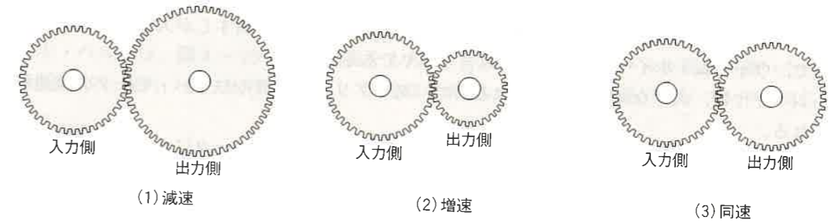
図4-20 ギヤの減速、増速及び同速
